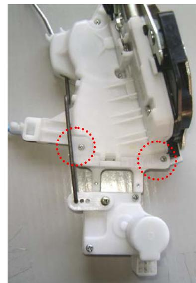
9. Fixe a trava na fechadura conforme foto acima utilizando os parafusos originais da fechadura
