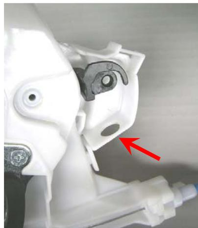
4. Com auxílio de uma furadeira, faça um furo de 8,00 mm de diâmetro no local indicado na foto acima com seta. Este furo é para passar a haste
